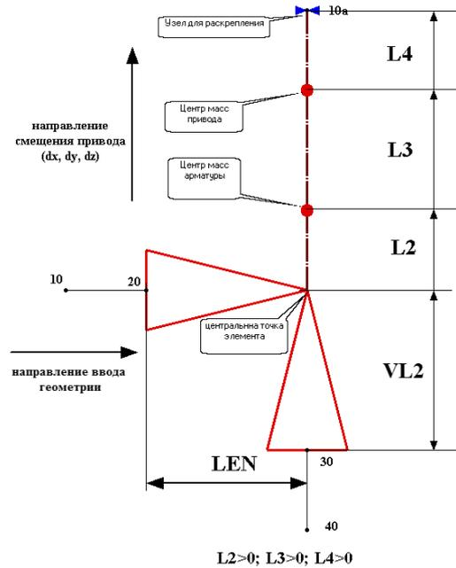
Расчетная схема углового клапана
