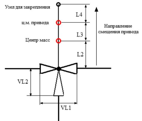
Расчетная схема трехходового клапана
