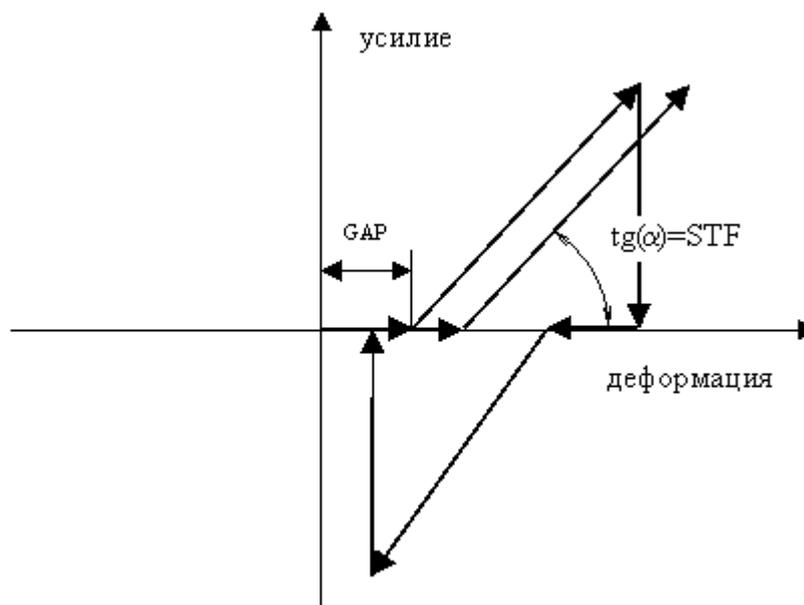
**Модель механического амортизатора**
