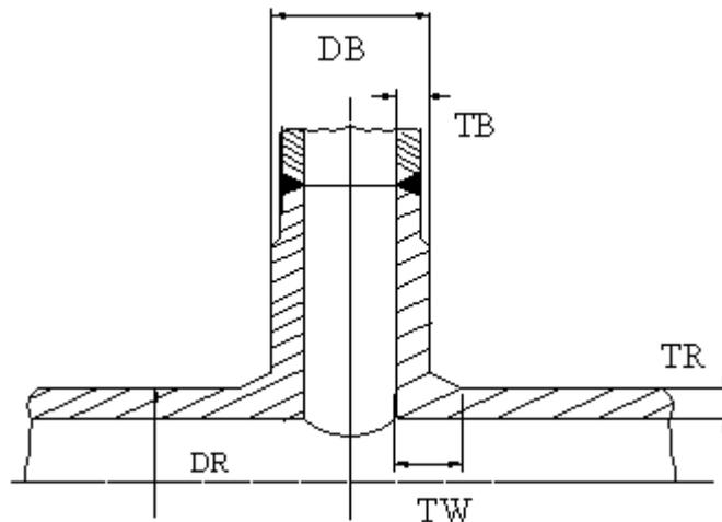
**Сечение тройникового соединения**
