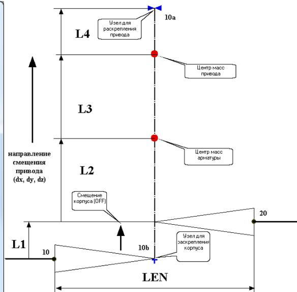
Расчетная схема клапана со смещением
