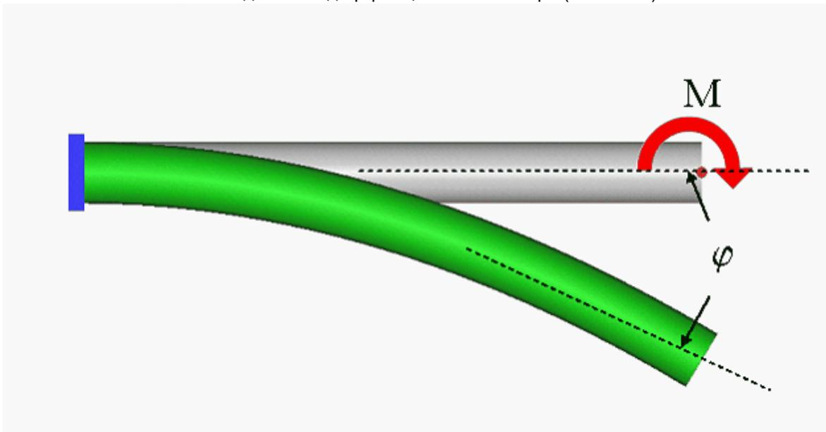
Схема изгибной деформации компенсатора ( $M = KB \cdot \varphi$ )
