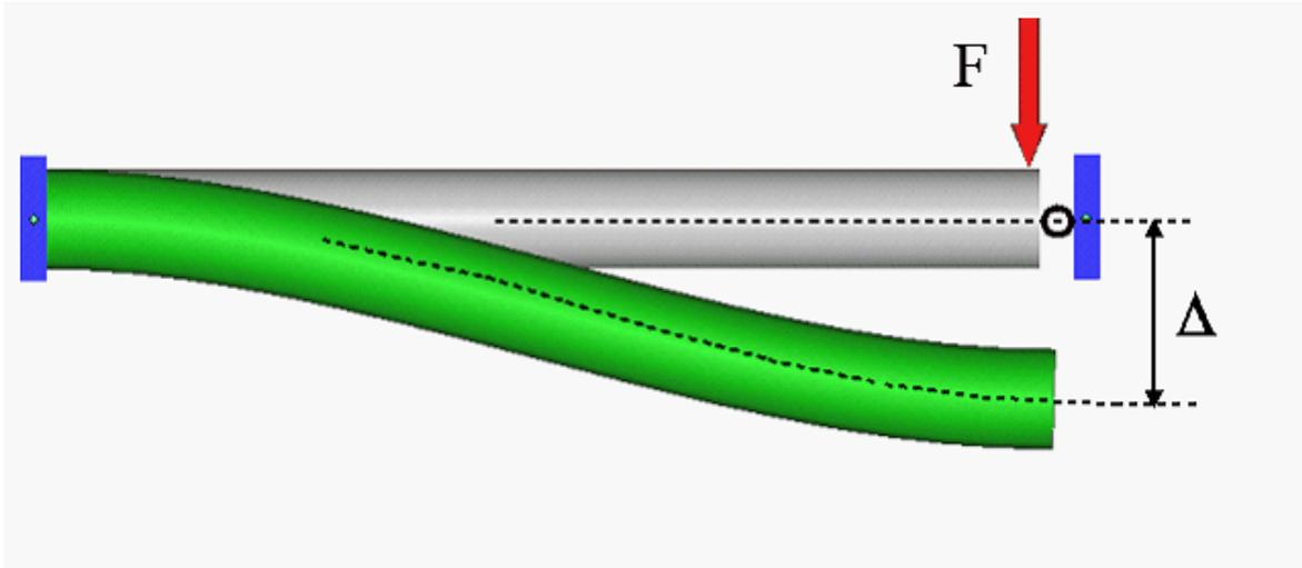
Схема сдвиговой деформации компенсатора ( $F = KS \cdot \Delta$ )
